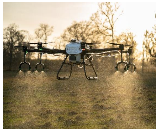
სურათი 1. აგროქიმიკატების დრონით გამოყენება, წყარო: Agrometa - Georgia
