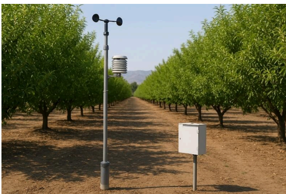
მეტეოროლოგიური სადგურები და მოდელირების სურათი 6. აგრო მეტეოროლოგიური სადგურები ლურჯი მოცვისა და ნუშის ბაღებში, წყარო Sensors & Smart Technologies | www.sst.ge
